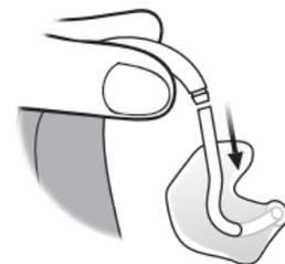
Desconecte el tubo y el molde del codo. Sostenga firmemente el codo al extraer el tubo. De lo contrario, puede dañar el audífono.
