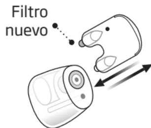
Empuje la punta vacía contra el filtro anticerumen del micromolde y tire hacia fuera.
