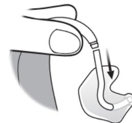
Déconnecter le tube et l'embout du coude. Tenez le coude fermement lorsque vous détachez le tube. Sinon, l'appareil pourrait être endommagé.
