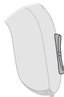
Appuyez quelques secondes à une extrémité du bouton pour activer le mode silencieux de l'appareil. Pour réactiver l'appareil, appuyez brièvement sur le bouton.
