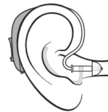
Insérez doucement l'embout dans votre conduit auditif jusqu'à ce que le tube fin se loge dans votre oreille. Si le tube fin possède une pièce de maintien, placez-la dans l'oreille de façon à ce qu'elle suive le contour de l'oreille.
