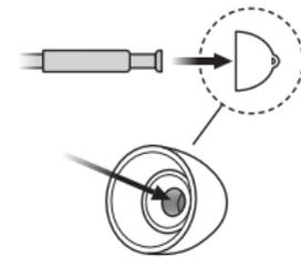
Insérez l'écouteur exactement au milieu de l'embout afin d'obtenir une fixation solide.
