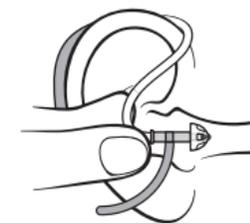
Tenez la courbe du tube fin entre votre pouce et votre index. L'embout doit être dirigé vers l'ouverture du conduit auditif.
