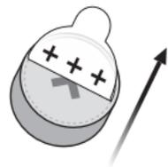
Retirez l'étiquette sur le côté positif (+) de la nouvelle pile.
