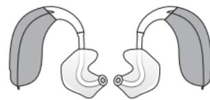
Assurez-vous de pouvoir identifier quel embout s'associe avec quel appareil avant de les déconnecter des appareils.
