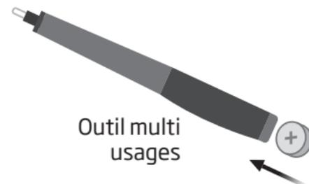
L'outil multi usages peut être utilisé pour changer la pile. Utilisez l'extrémité magnétique pour retirer et insérer les piles.
