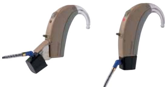
Branchez le cordon de programmation sur le sabot en respectant les points rouges. L'appareil doit être en marche durant la programmation. Faites-le en tournant le potentiomètre sur la position 2.
